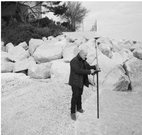
Figura 4. Fase del rilievo con GPS RTK.
