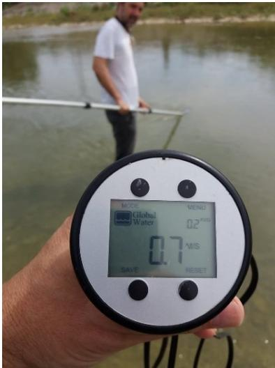
*Fase della misura della velocità della corrente idrica per mezzo di correntometro dotato di un mulinello all'estremità e da una centralina con visualizzatore digitale*
