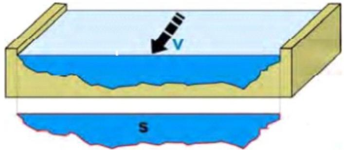
La portata è, per definizione, il volume liquido che attraversa una sezione nell'unità di tempo. Il suo valore è espresso in metri cubi al secondo (m<sup>3</sup>/s).
