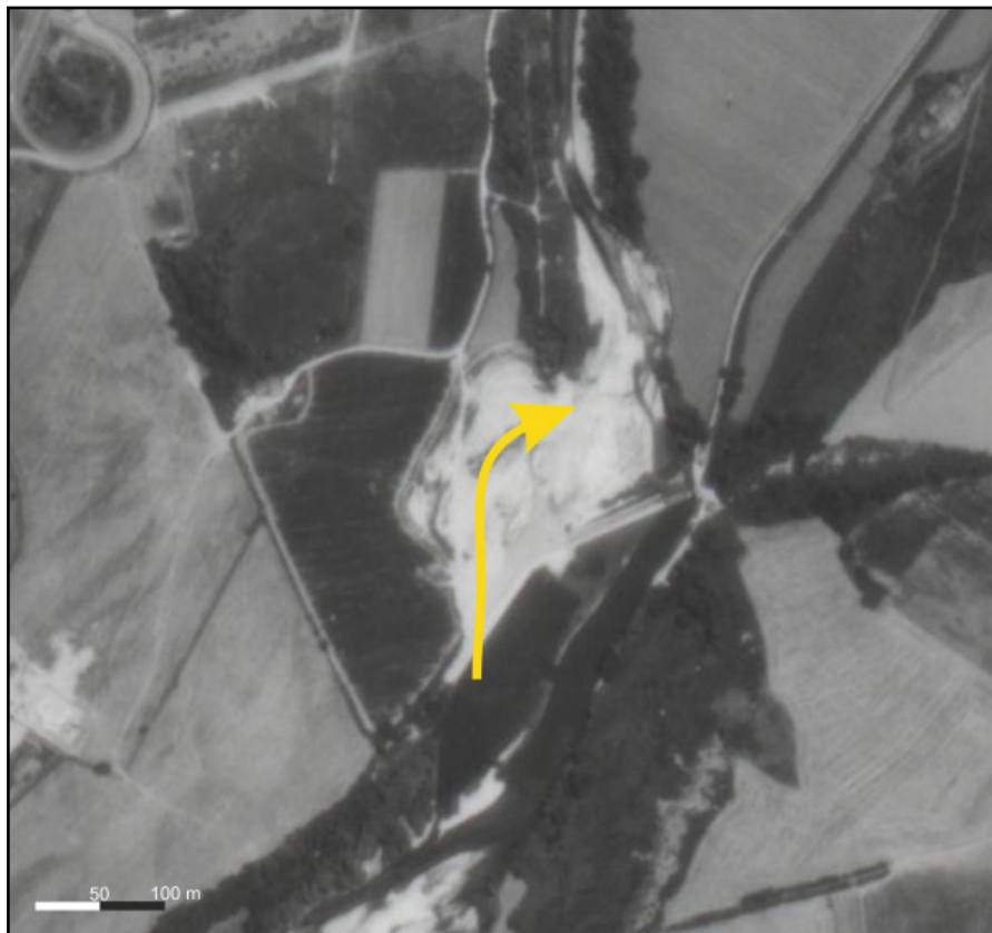
Figura 5 – Volo Regione Marche 1991. Aggiramento della briglia Enel in sinistra idrografica (freccia gialla).
