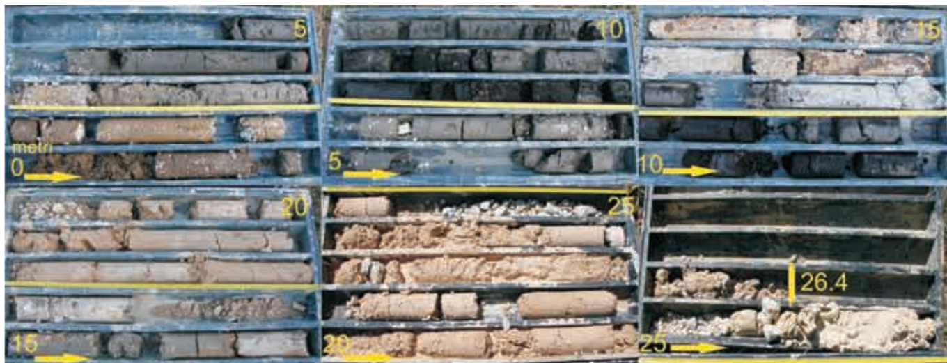
Le carote del carotaggio continuo realizzato (foto A. Dignani)
