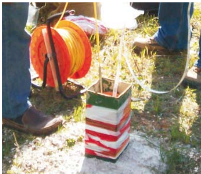
Il Piezometro, la fase di monitoraggio (foto A. Dignani)
